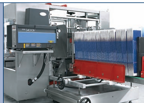
Magazzino allungato fino a 160 cartoni Extra storage up to 160 cases Magasin supplémentaire jusqu'à 160 cartons
