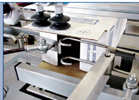
Chiusura falde inferiori con colla a caldo Closing of the bottom flaps by hot glue Fermeture des rabats inférieurs avec colle à chaude
