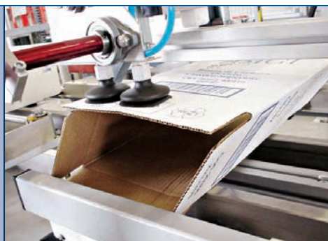
Apertura del cartone in orizzontale Horizontal opening of the case Formage du carton en horizontal
