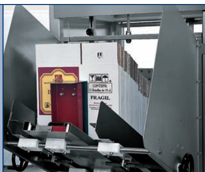
Magazzino cartoni 75 pezzi Case storage 75 pieces Magasin de cartons 75 pièces
