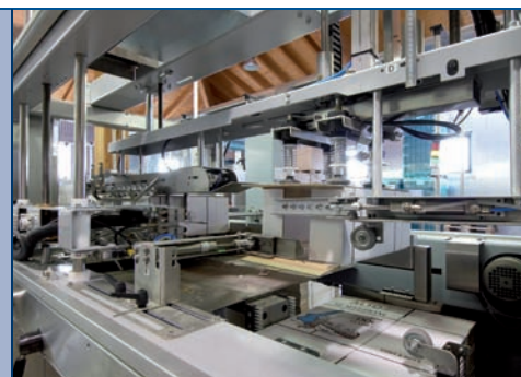
Formatura del cartone in orizzontale Horizontal opening of the case Formage du carton en horizontal
