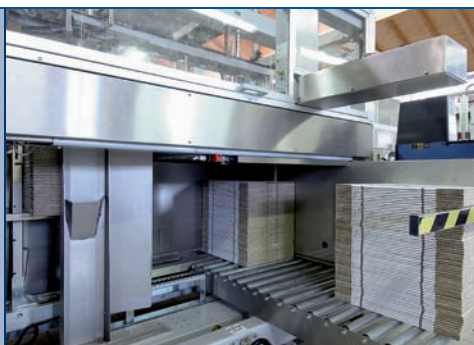
Magazzino cartoni fino a 240 pezzi Storage up to 240 cases Magasin de cartons jusqu'à 240 pièces
