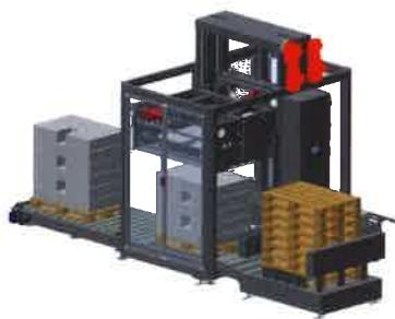
Palletizzatore PAL 35 versione totalmente automatica, completa di rulliera alimentazione ed espulsione pallet e magazzino pallet vuoti.
