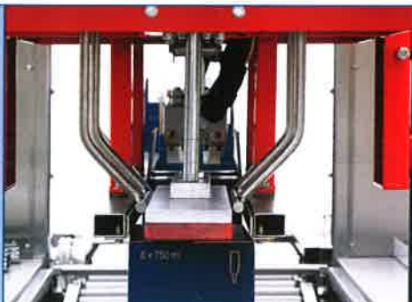
Sigillatura con pressore a cartone fermo Sealing pressing device with the case stopped Fermeture avec presseur de carton arrêté
