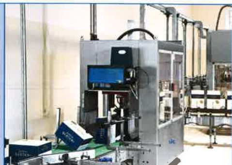
Ribaltatore cartoni per stoccaggio bottiglie stese Carton-turning conveyor for lying storage Retourneur de cartons pour stockage couché
