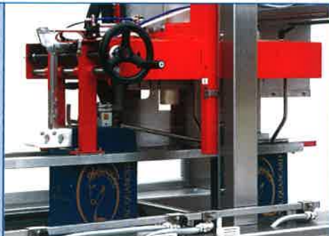
Traino cartoni "passo-passo" a barre Bar-type "step-by-step" case conveyor Entraînement des cartons "pas à pas" à barres
